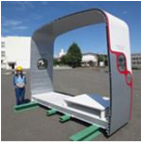
図 2 試作した高速鉄道車両部分構体の外観写真 出典：NEDO ホームページ https://www.nedo.go.jp/news/press/AA5_100973.html )
