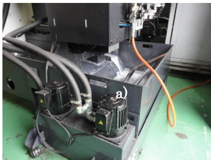
a) クーラントタンク b) ペーパーフィルター#500 c) スコップでペール缶にすくい上げる
