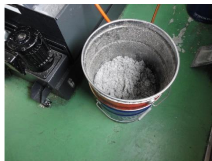
d) Mg 回収ペール缶 (底に水抜き穴をあけておく) e)クーラント液回収ペール缶
