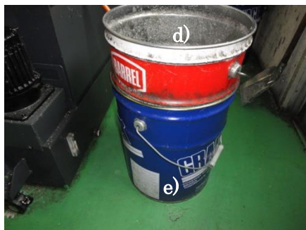
d) Mg 回収ペール缶 (底に水抜き穴をあけておく) e)クーラント液回収ペール缶
